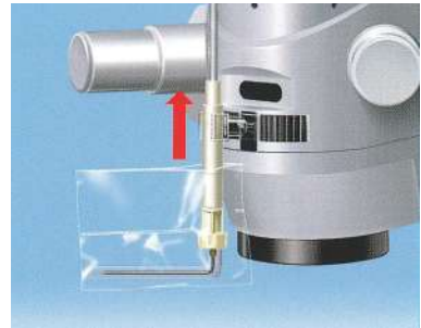
6 キャタップ本体を固定用具に下から滑り込ませて取付けます。
