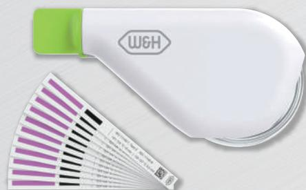
ヘリックテストは、クラスB滅菌器用のテストデバイスです。滅菌器の空気除去及び蒸気透過能力を評価するためのプロセス・チャレンジ・デバイス（PCD）に分類されます。中腔器具が適切な滅菌状態を保っているかをシミュレートします。
