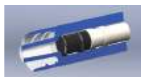
従来のガスケット構造
