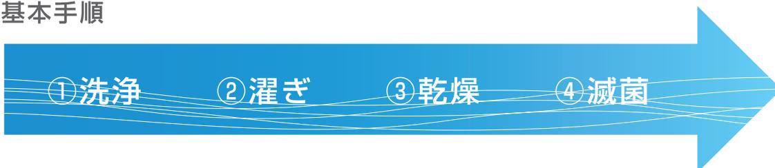
器具は使用後直ちに洗浄し、純水で濯ぎを行います。完全に乾燥させた後、各器具に適した方法で滅菌を行ってください。洗浄・乾燥後は、汚れが完全に除去されていること、及び器具の作動チェックを行うようにしてください。
