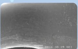
ステンレス製器具にレビテクス超音波500回照射
